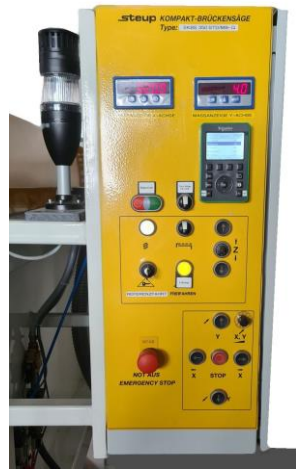
Machine operation standard at the control cabinet Maschinenbedienung Standard am Schaltschrank
