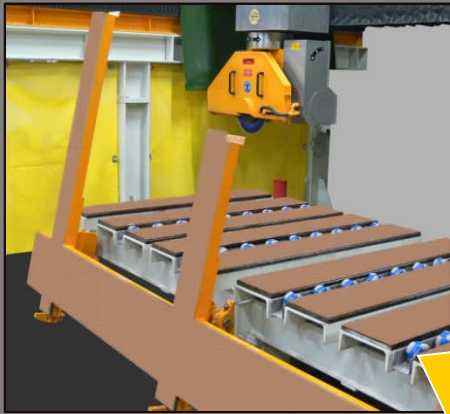
TISCH MIT ALLSEITEN -ROLLENSYSTEM AUSGESTATTET
